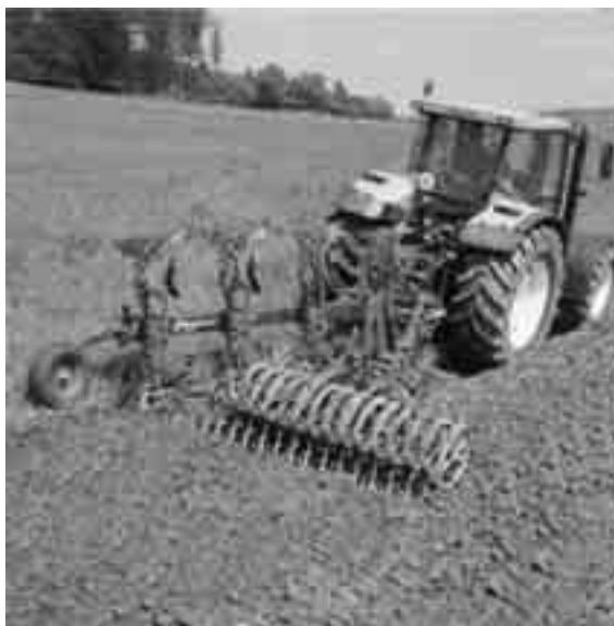
Fig. 1.16 Soms wordt de vorenpakker aan de ploeg bevestigd.
