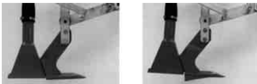
Fig. 5.12 Het verschil tussen een sleepvoet (links) en een sleufkouter (rechts)
