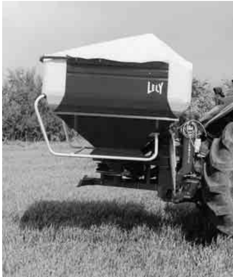
Fig. 4.20 De weeginrichting bevindt zich tussen de kunstmeststrooier en de hefinrichting.
