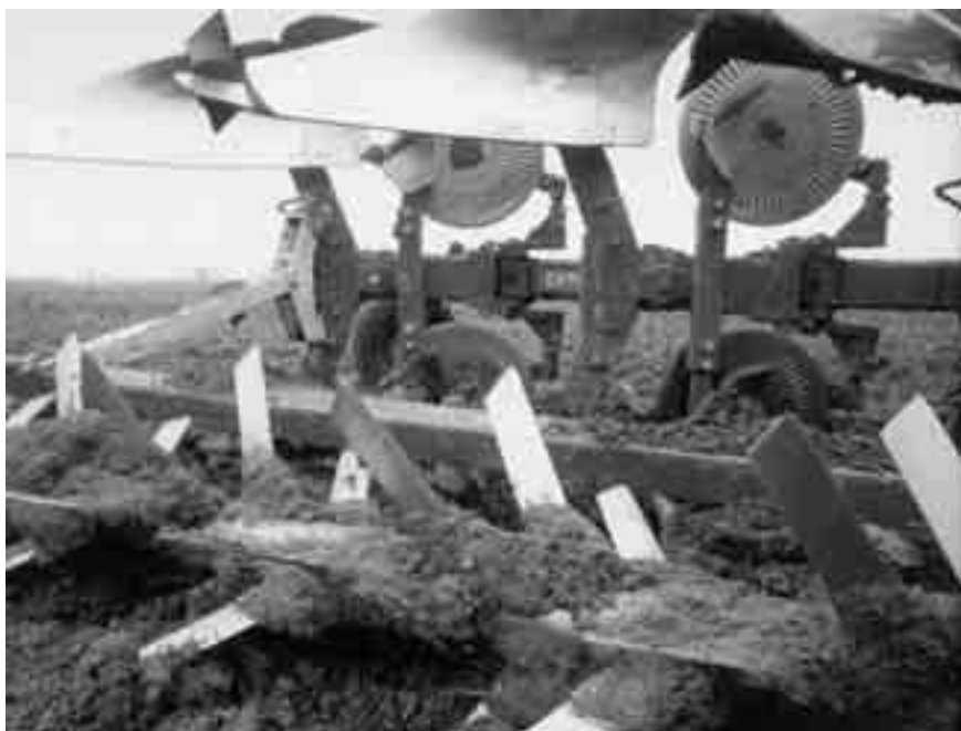
Fig. 1.17 Een snedemixer legt de grond in één bewerking enigszins vlak.
