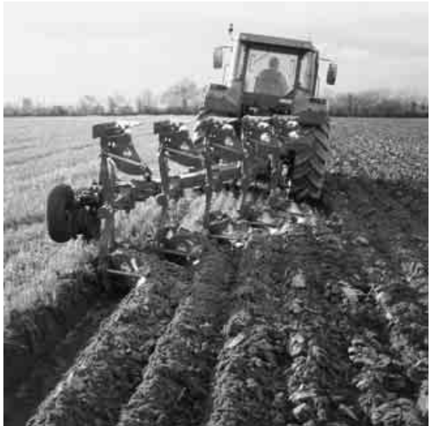
Fig. 1.4 Een aanbouwentelploeg wordt gekoppeld in de driepunshenrichting.
