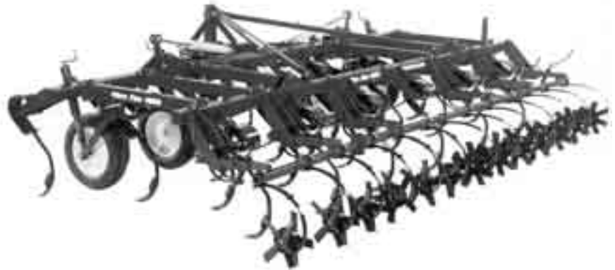
Fig. 2.3 Een triltandcultivator heeft veel tanden.
