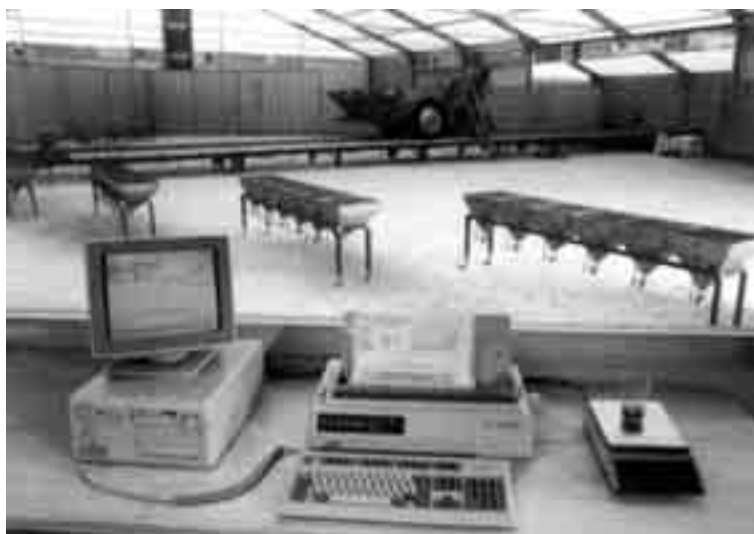
Fig. 4.9 Het bepalen van de dwarsverdeling in een speciale hal
