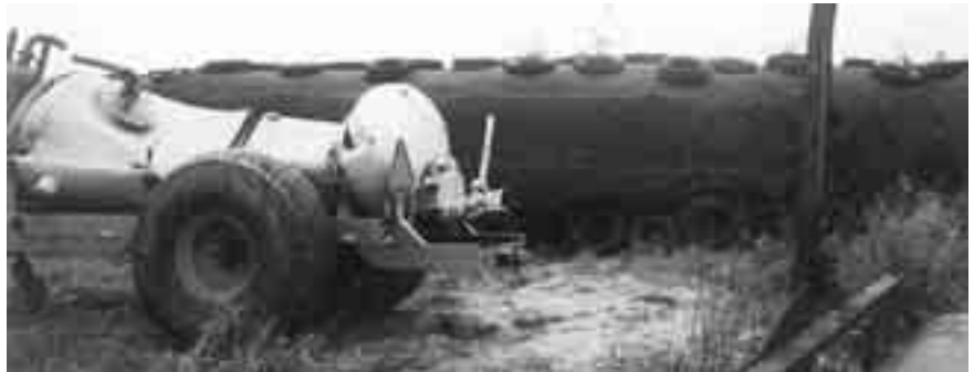
Fig. 5.3 Bij een te groot vacuüm kan de vacuümtank in elkaar klappen
