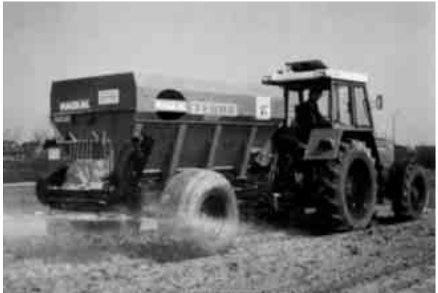
Fig. 4.5 Een kalkstrooier met strooischijven
