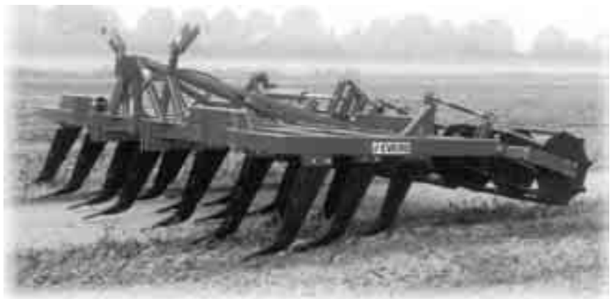
Fig. 2.4 Een vastetandcultivator wordt gebruikt om vastgereden sporen los te trekken of om stoppels te bewerken.
