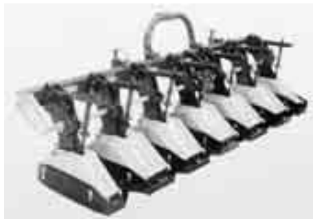
Fig. 3.4 De strokenfrees wordt ingezet voor onkruidbestrijding in maïs.
