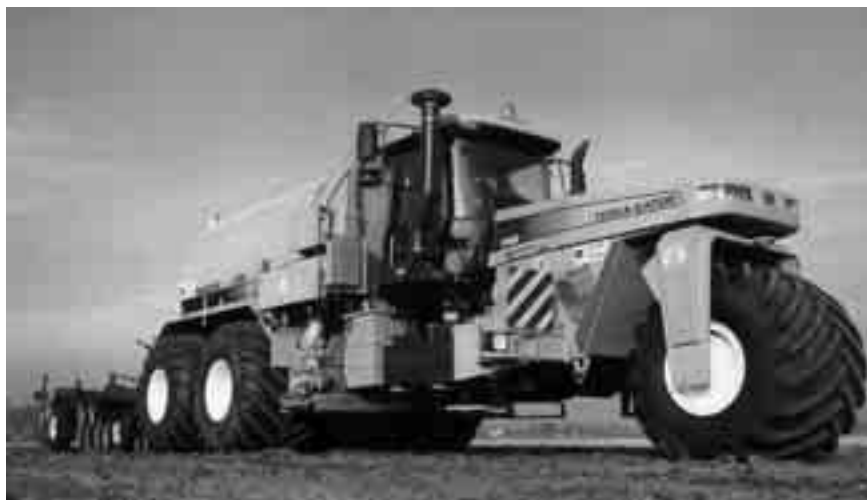
Fig. 4.0 Een zelfrijdende machine brengt vloeibare organische mest in de grond.
