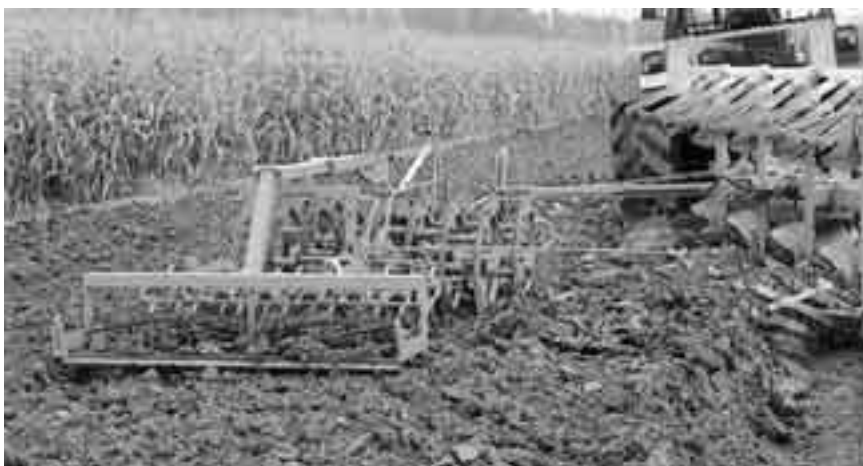
Fig. 1.15 Een vorenpakker wordt vaak door een ploeg meegetrokken.
