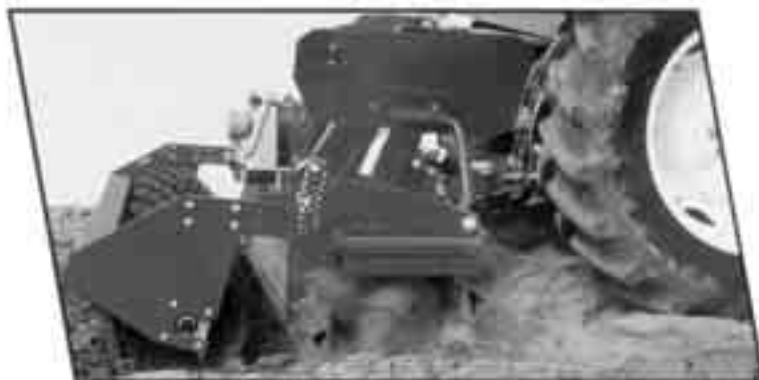
Fig. 3.10 Voor en achter de tanden van een eg bevinden zich egalisatieplaten.
