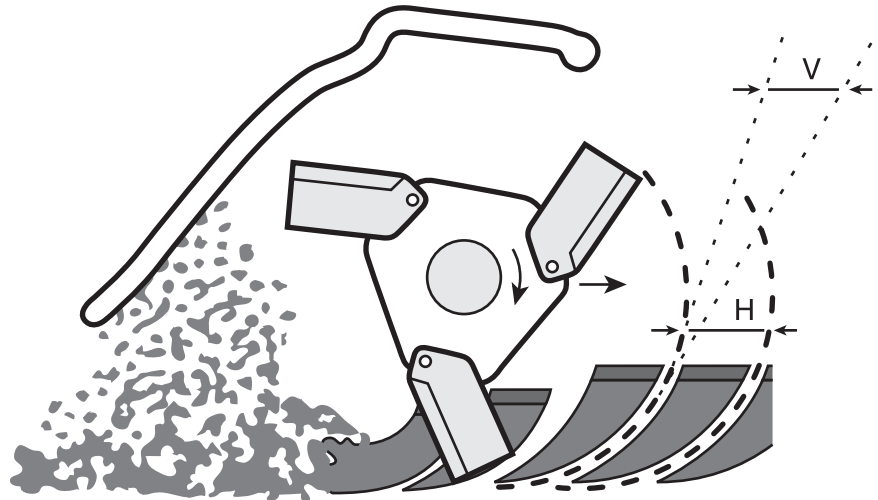
Fig. 3.12 De haplengte en de vrijloophoek van het freesblad zijn afhankelijk van de rijsnelheid.
