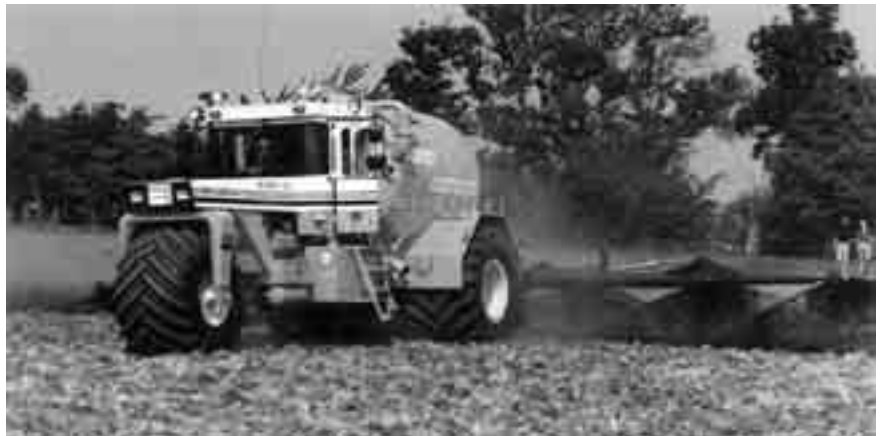
Fig. 4.6 Vloeibare schuimaarde kun je uitrijden met een drijfmesttank met een sproeiboom.
