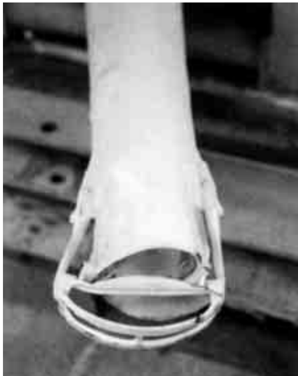
Fig. 4.19 Bij de pendelstrooier is het beugeltje heel belangrijk voor een goede verdeling.
