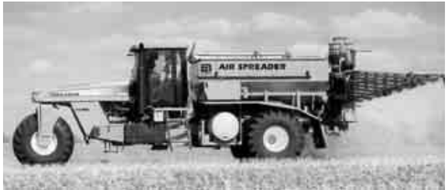
Fig. 4.3 Een zelfrijdende pneumatische kunstmeststrooier is geschikt als je zeer nauwkeurig moet werken.
