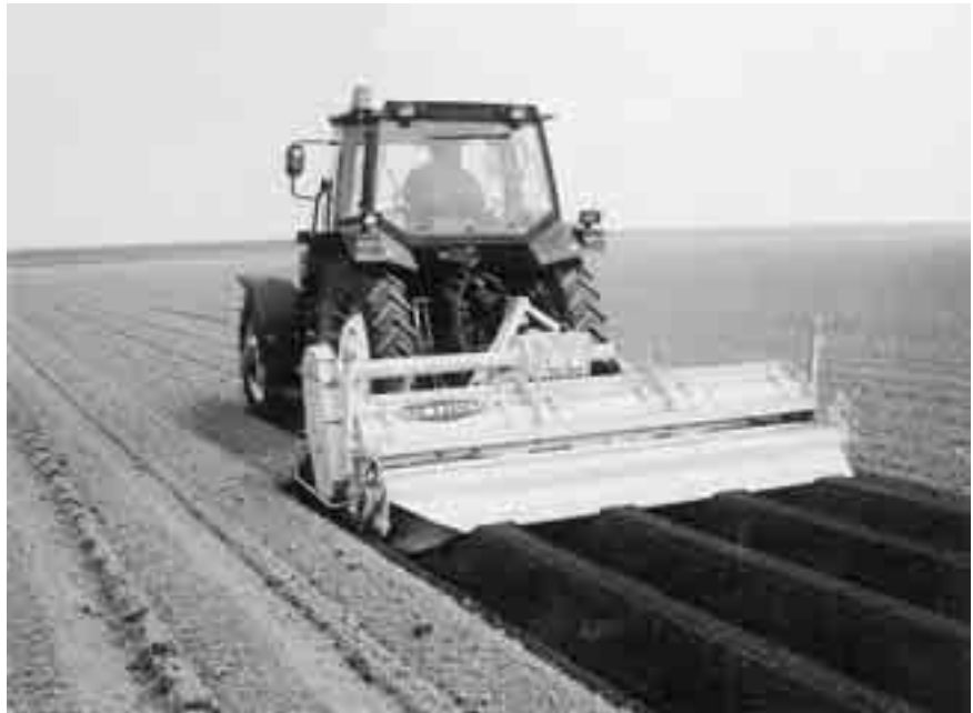
Fig. 3.3 Hakenfreesen kunnen gebruikt worden voor het frezen van aardappelruggen.
