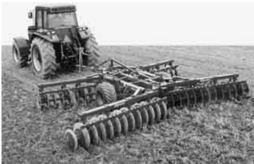
Fig. 2.9 Schijveneggen worden vooral gebruikt voor bewerkingen na de oogst.
